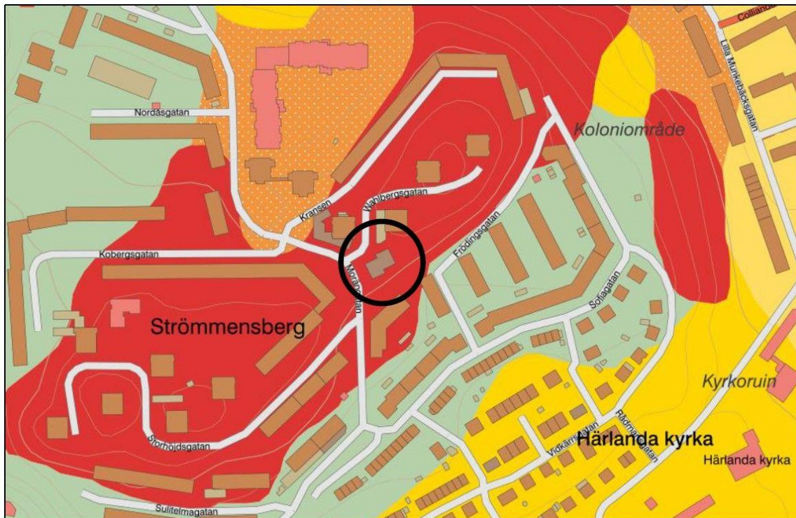
Figur 13: SGU:s jordartskarta. Rött område visar läge för berg i dagen. Orange-markerat område visar läge för sand. Grönt område visar läge för morän omväxlat med sorterade material. Gult område visar läge för lera
